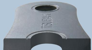
Nuestro exclusivo proceso de troquelado en anillo comprime el material alrededor de los orificios de paso, creando tensiones residuales positivas que son críticas para ampliar la duración ante la fatiga.
