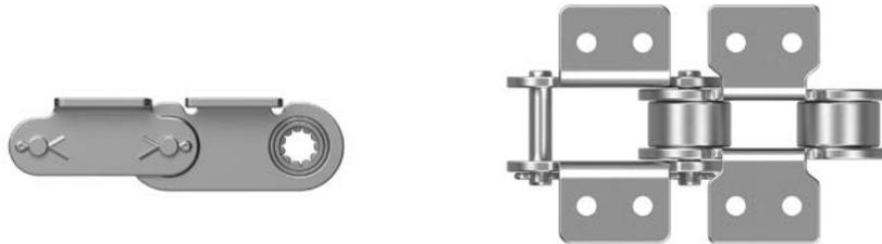
La cadena con bujes con rodamiento Tsubaki prácticamente elimina el estiramiento inicial al colocar un rodamiento de agujas entre el pasador y el área del buje. La cadena con bujes con rodamiento ofrece una excelente resistencia al desgaste sin necesidad de lubricación adicional.
