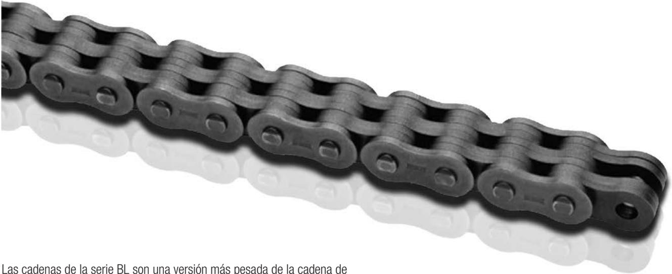
Las cadenas de la serie BL son una versión más pesada de la cadena de elevación que, en la mayoría de los casos, reemplazó a las cadenas de elevación de la serie AL. Las cadenas BL se fabrican con un pasador y una placa más grandes que los que se utilizan en las cadenas de la serie AL similares. Tsubaki ofrece cadenas de elevación series AL y BL.
